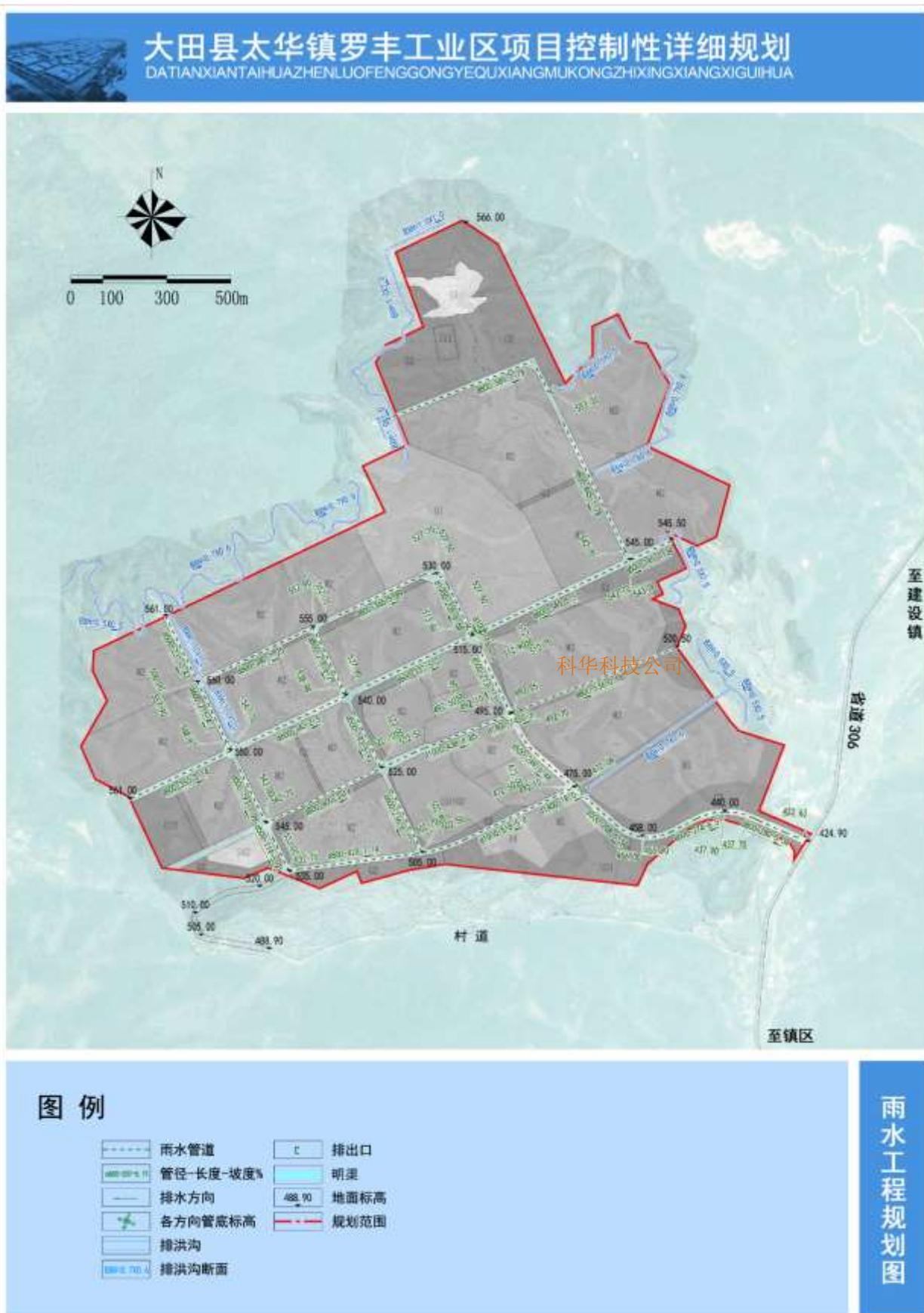
图 4-3 项目区域雨水工程规划图
