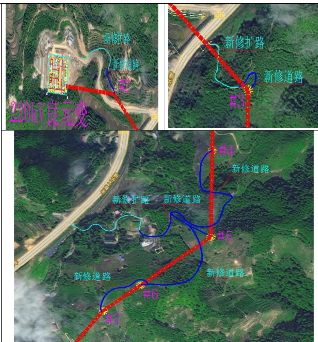
图 2-2 施工便道设置示意图
