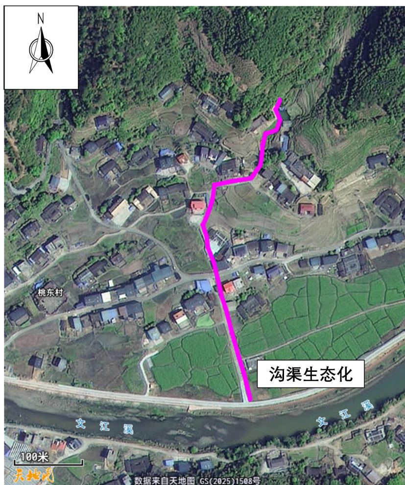
图 2- 25 文江溪沟渠生态化平面布置图
