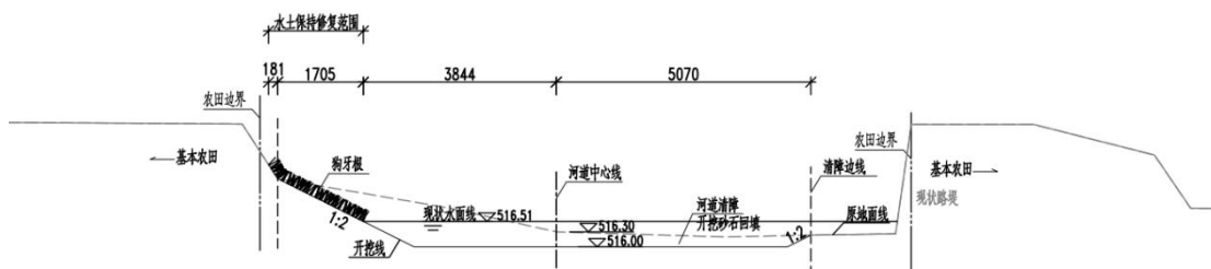
图 2-16 建设溪段水土保持生态修复护岸型式
